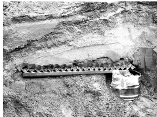
Abb. 1: In den ungestörten Boden eingebautes 1,25 x 1,25 m großes Lysimeter. Das über die Rippen ablaufende Wasser wird über eine querlaufende Rinne zur Zwischenspeicherung in ein Fass geleitet.
