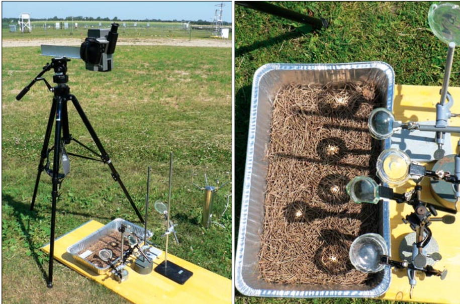
Abb. 1: Versuchsaufbau: Anordnung der Thermografiekamera und der fünf Glasscherben über einer Streuschale
